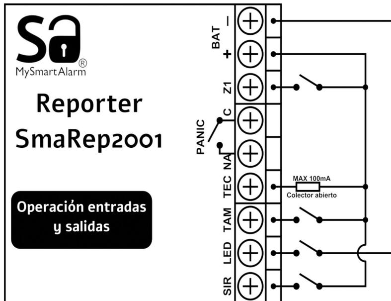
Siguiendo el diagrama usted podrá adaptar Reporter a la mayoría de los paneles del mercado. Recuerde que todas las entradas y la salida TEC pueden ser invertidos en el setup.
